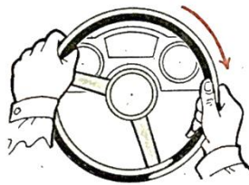
ภาพที่ 2 การจับพวงมาลัยเฉียงขวา ที่มา : (อำพล ชี้อตรง, 2562)
